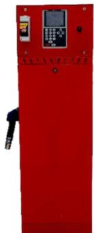
4. Установка для учета нефтепродуктов «СБК-800» 24 В, точность 0.25%, производительность 800 литров в минуту. Для учета топлива при сливах с железнодорожных цистерн.
